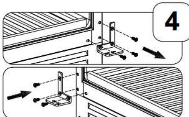
5. 卸下限位塊，安裝在門體的左側。把門軸鐵插入剛剛裝好的限位塊，然後把門體上門軸孔對準左上門鉸插入，接著把門體下側套入左下門鉸，最後用螺絲把門軸鐵鎖緊在左下門鉸。
