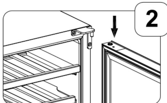
2. 擰開右上門鉸螺絲，拆下右上門鉸。取下左側的裝飾釘，將配件袋新的門鉸安裝到左上側，將裝飾釘裝入右上方。
