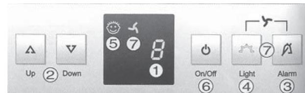
(1) 溫度顯示器：正常狀況下顯示酒櫃目前溫度或故障燈號。
